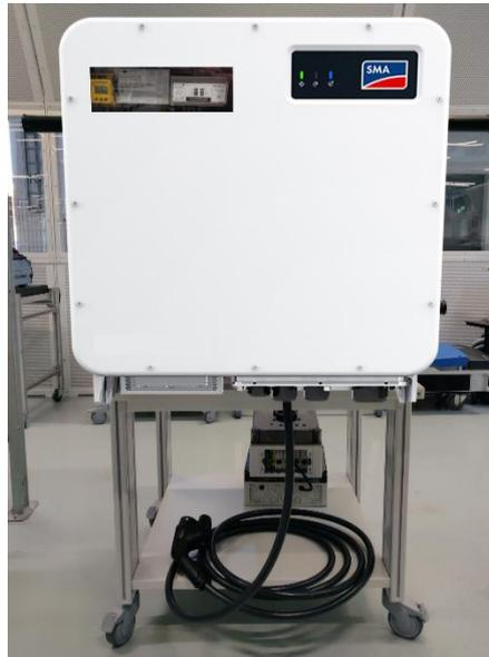
Bild 9: Versuchsmuster bidirektionale DC-Ladestation auf Basis angepasster Großserien-Wechselrichtertechnik
