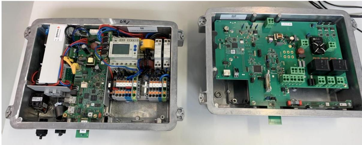
Bild 15: erstes Funktionsmuster im Gehäuse des alten EV Chargers
