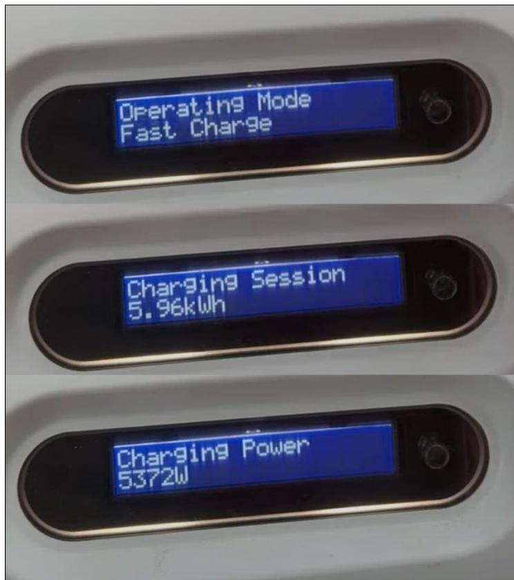
Bild 19: Display mit Anzeige des Lademodus, bisher geladener Energie und aktueller Ladeleistung
